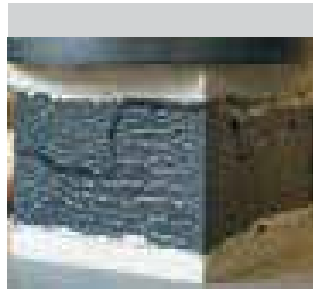
Bild 1: Zentrische Druckbelastung auf einen FOAMGLAS® PERINSUL Probekörper im Mörtelbett (Mörtel oben und unten).
