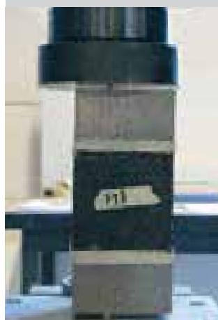
Bild 2: Exzentrische Druckbelastung auf einen FOAMGLAS® PERINSUL Prüfkörper.
